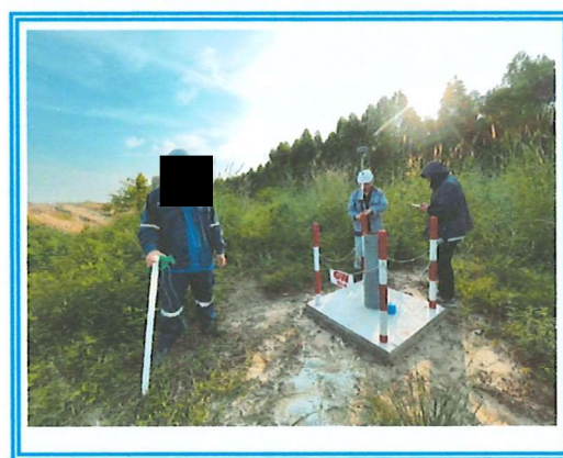
รูปที่ 1 แสดงการวัดระดับชั้นความสูงของปากบ่อสังเกตการณ์น้ำใต้ดิน และพื้นดิน ด้วยเครื่องรับสัญญาณดาวเทียม GNSS RTK
