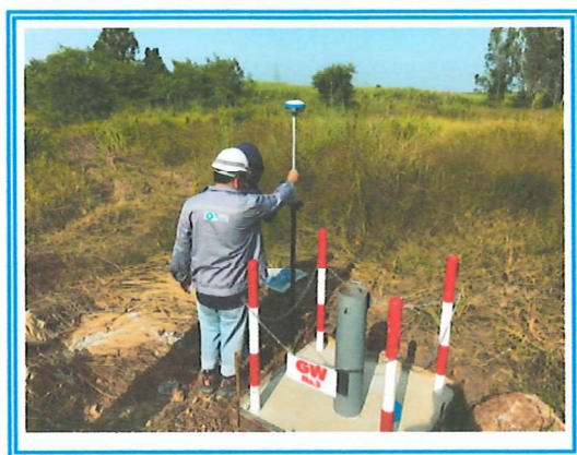
รูปที่ 1 แสดงการวัดระดับชั้นความสูงของปากบ่อสังเกตการณ์น้ำใต้ดิน และพื้นดิน ด้วยเครื่องรับสัญญาณดาวเทียม GNSS RTK
